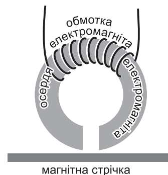
Рис. 27.4. Схематичне зображення записувальної та відтворювальної головки магнітофона поблизу магнітної стрічки.
