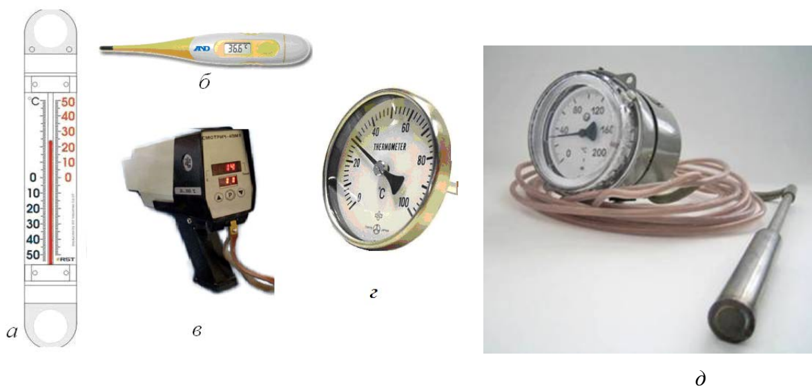
Мал. 229. Термометри різних конструкцій: а – рідинний, б – електричний, в – безконтактний (пірометр), г – біметалевий, д – газовий
