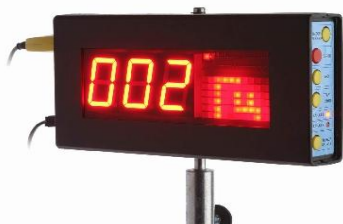
Рис.4. Секундомір демонстраційний Результати вимірювань виводяться на екран комп'ютера. Цифрові прилади, що входять до цього блоку дозволяють вимірювати наступні фізичні величини: час (0-999с, точність 0,001-0,1с в залежності від інтервалу, що вимірюється), силу постійного струму (0-10А та 0-999мА), силу змінного струму (0-999мА), напругу постійного
